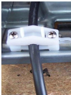
Figura 13: Particolare doppio fissaggio del cavo
