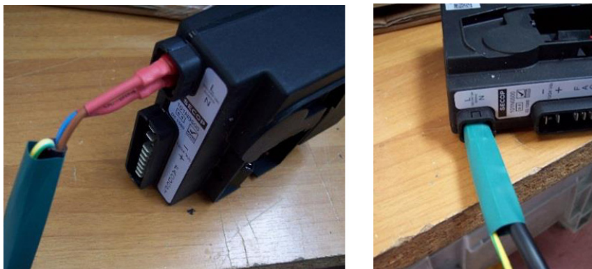
Рисунок 11: Деталь соединения с двойной изоляцией
