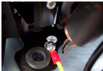
Afbeelding 12: Detail aansluiting aardkabel aan het metalen deel van de compressor
