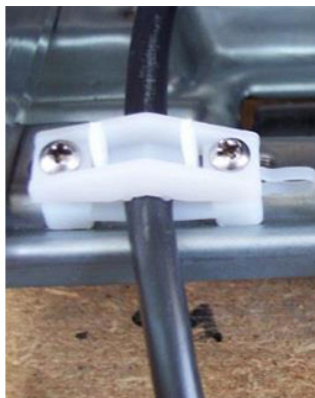
Afbeelding 13: Detail dubbele bevestiging van de kabel
