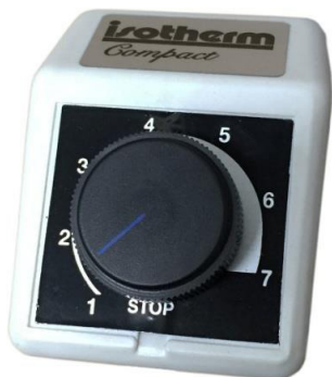
Afbeelding 8: Voorbeeld van een thermostaat gebruikt in Compact Classic met een schaalverdeling van 1 (hoogste temperatuur) tot 7 (laagste temperatuur)
