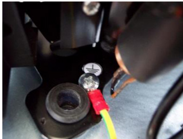
Figur 12: Detalj av anslutning av jordkabeln på kompressorns metallstruktur
