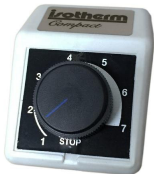
Kuva 8: Esimerkki Compact Classic -mallissa käytetystä termostaatista, jonka asetusväli on 1 (korkein lämpötila) - 7 (alhaisin lämpötila)
