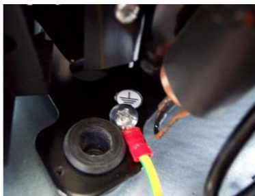
Kuva 12: Maadoitusjohto kompressorin metalliosassa
