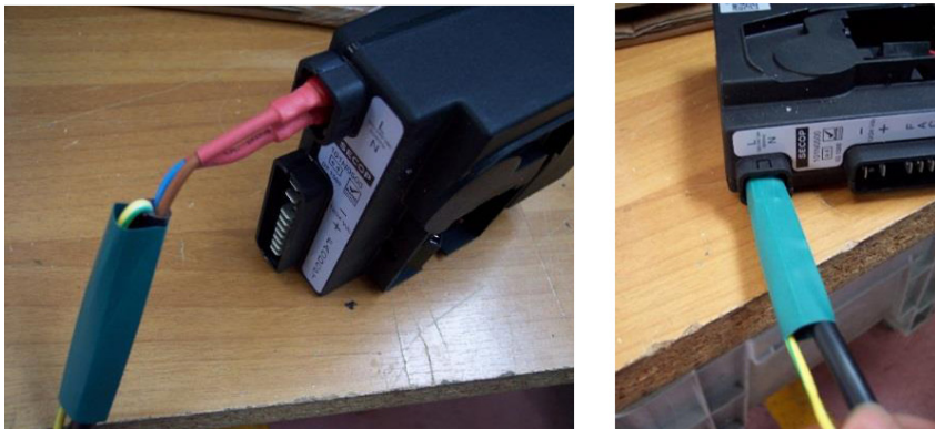
Figura 11: Particolare connessione doppio isolamento
