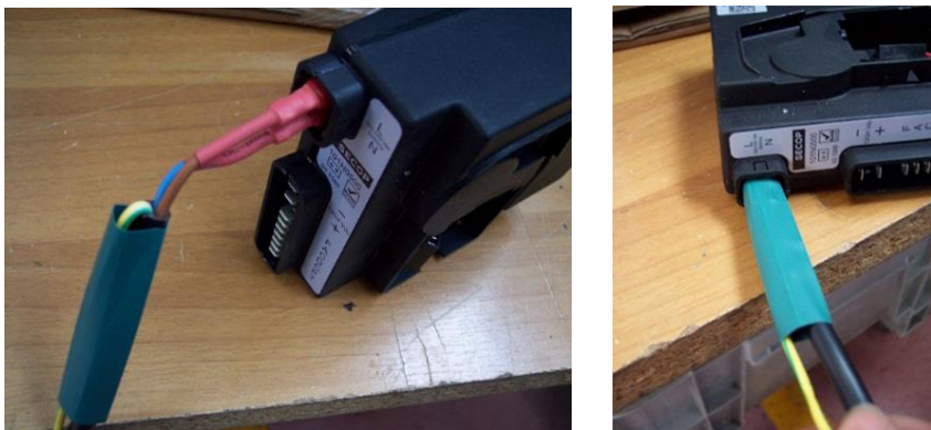
Figura 11: Detalle de conexión con doble aislamiento
